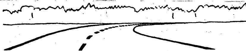
Fig 56. Med hjälp av övergångskurvans stora formverkan i förhållande till båglängden kan man åstadkomma en bättre lösning av problemet än som visades i fig 50 och 51 utan särskilt stor avvikelse i sidled.
