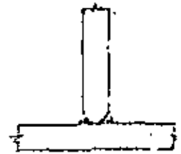
c2. SOLDADURAS DE PENETRACION
