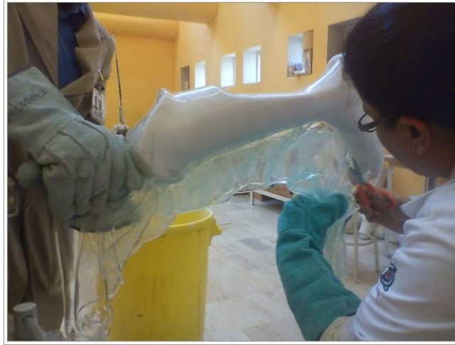
Figura 8. Colocación del PP sobre el molde y retiro del material excedente.
