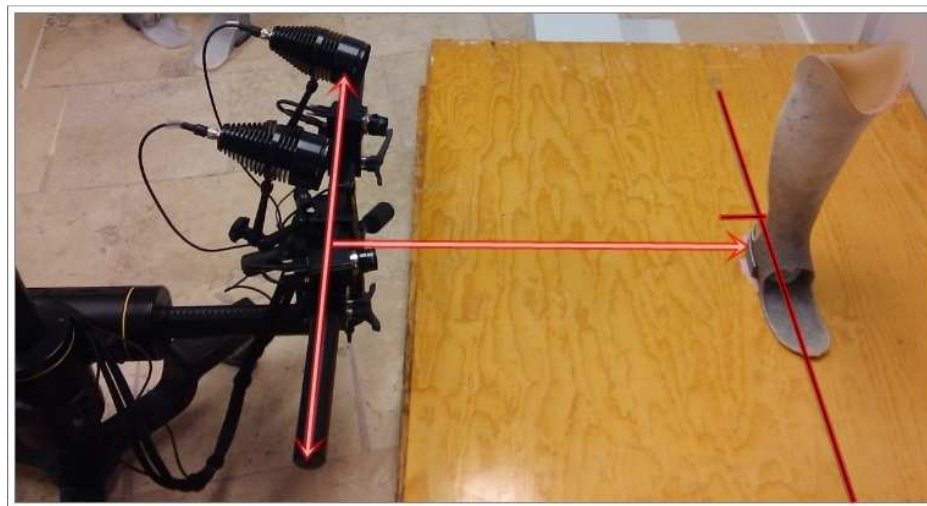
Figura 88. Acomodo de las cámaras para lograr que sean perpendicular a la muestra.
