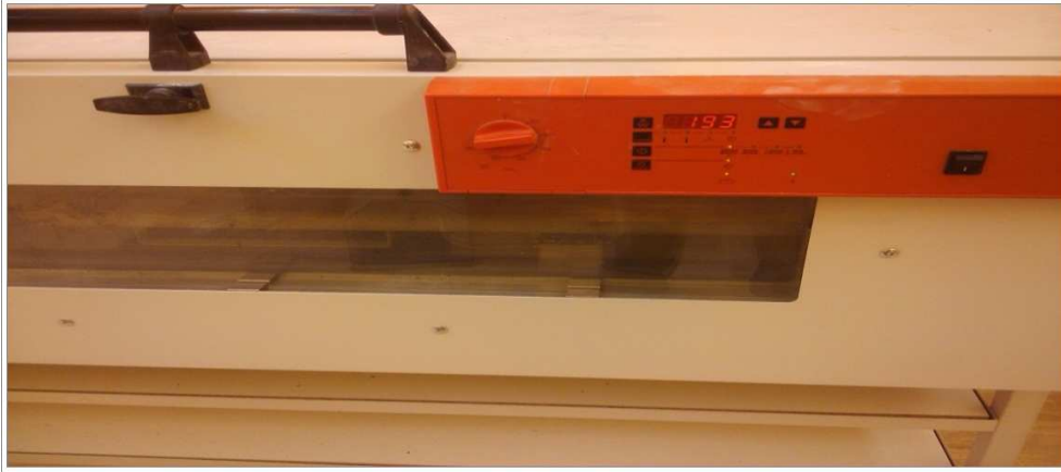
Figura 6. Temperatura del horno para plastificar con PP.
