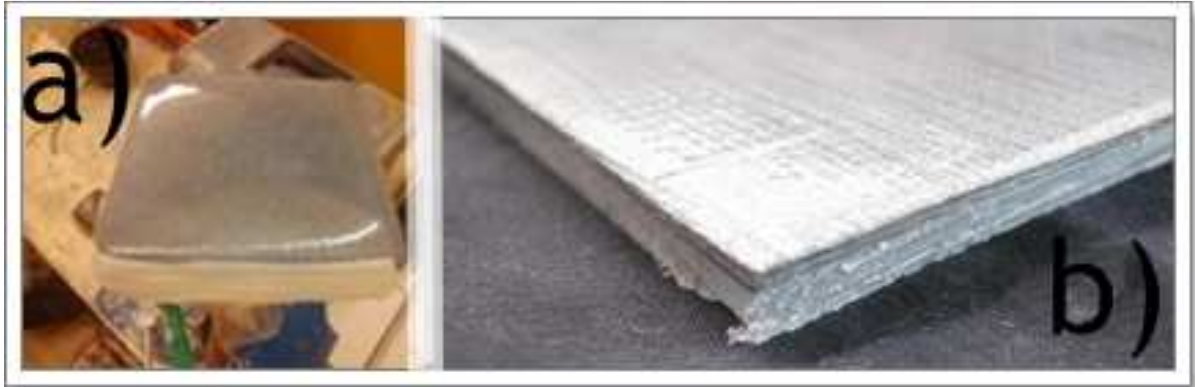
Figura 52. Imagen del compuesto. a) Probeta después de un día de catalizar, b) Probeta cortada.
