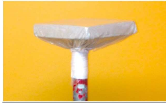
Figura 46. Colocación y amarre de la bolsa de PVA.
