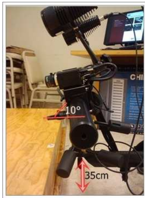
Figura 82. Posición de cámaras e iluminación durante mediciones en sistemas protésicos.
