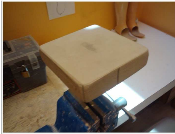
Figura 45. Molde de yeso de 15x15m para la probeta del material compuesto.
