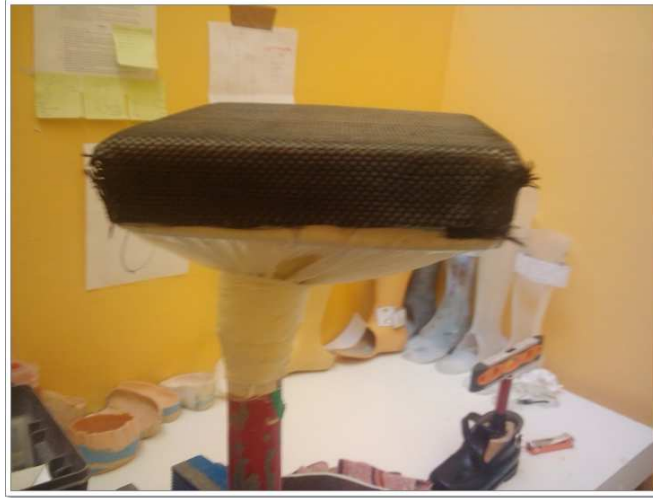
Figura 48. Colocación de la fibra de carbón.
