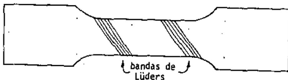
Figura 45 : Representación esquemática de la aparición de Bandas de Lüders en una probeta deformada por prueba de tracción
