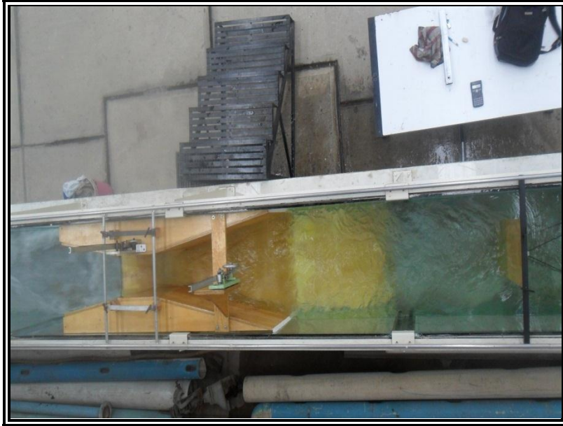
Figura 87. Colocación de la pantalla a 1.53 m antes del modelo, vista en planta.
