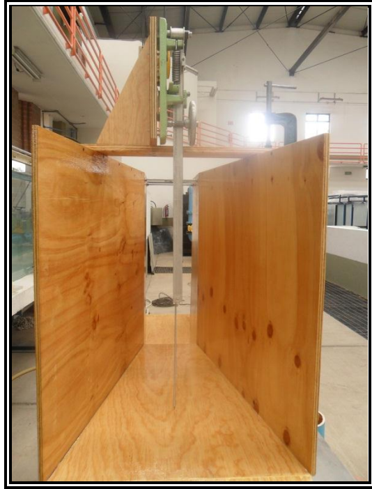
Figura 42. Colocación de un limnómetro a la entrada del Parshall.
