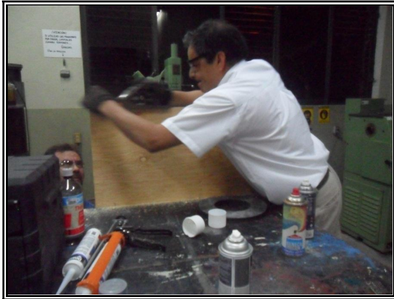
Figura 40. Ajuste de acabado con cepillo de madera.
