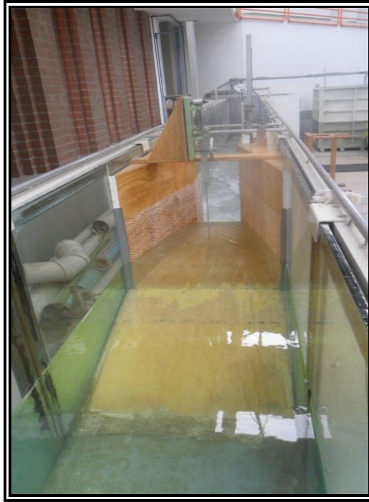
Figura 76. Comportamiento del flujo para gastos bajos para una rugosidad de 4 mm.
