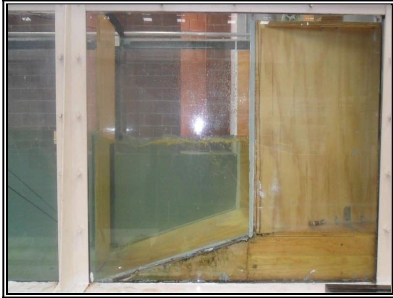
Figura 84. Colocación de la pantalla a 0.75 m antes del aforador, vista de perfil.
