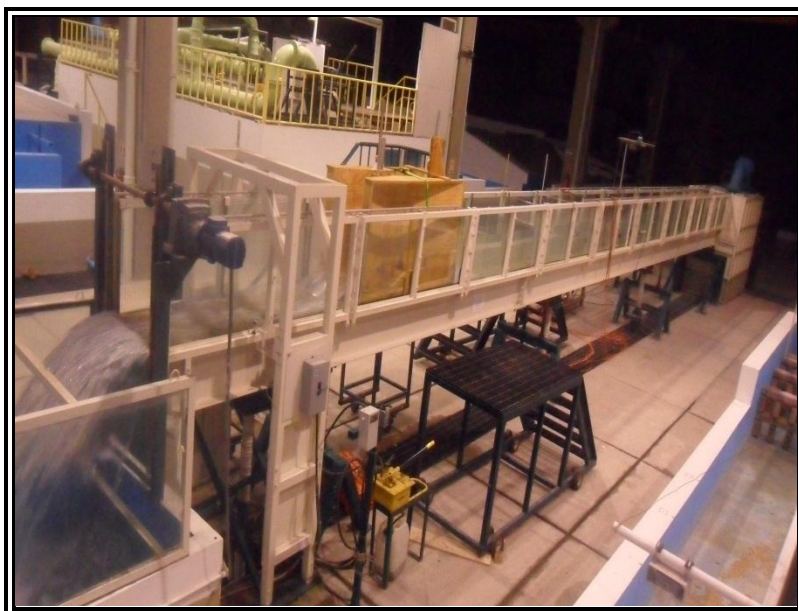
Figura 117. Canal de pendiente variable con S = -0.0060 .
