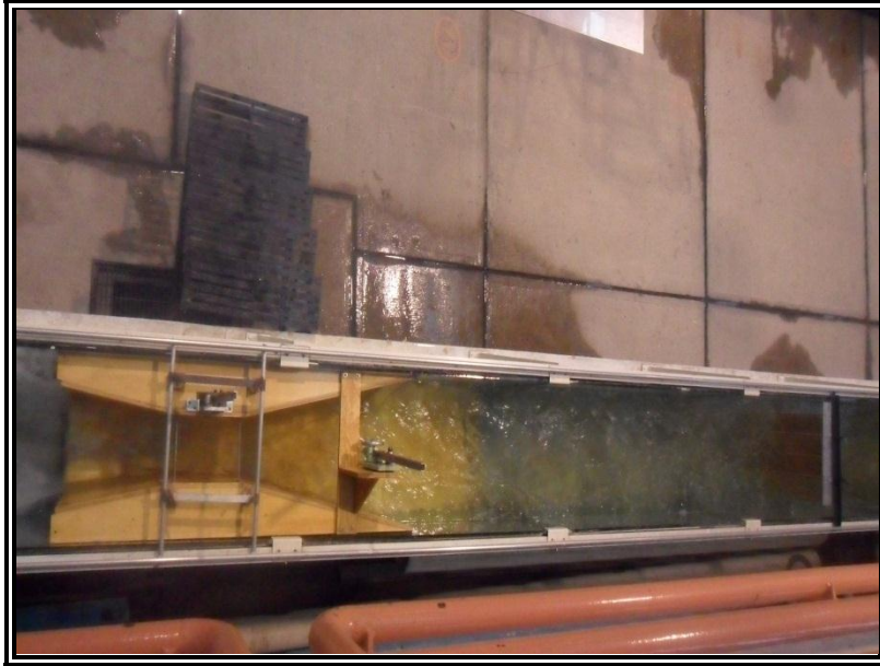
Figura 112. Colocación del desviador a 3.00 m antes del aforador, vista en planta.
