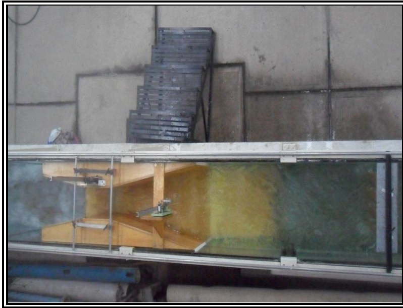
Figura 104. Colocación del desviador a 1.53 m antes del dispositivo, vista en planta.
