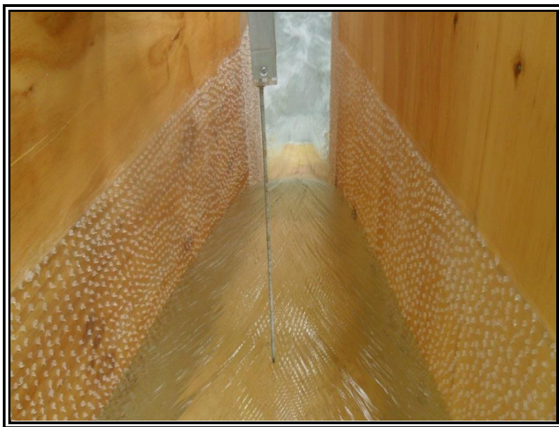
Figura 75. Comportamiento del flujo para gastos altos para una rugosidad de 4 mm.
