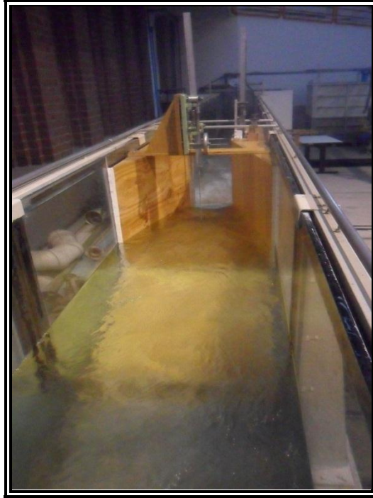
Figura 114. Disipación de vórtices en el desviador ubicado a 3.00 m antes de la entrada al modelo.
