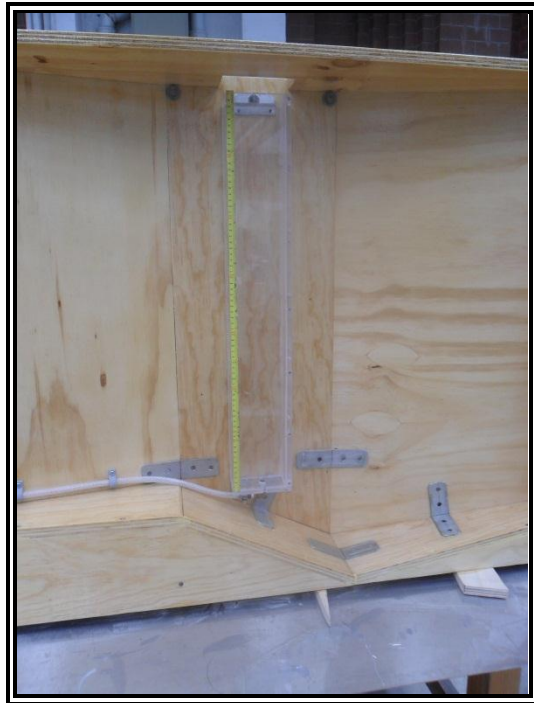
Figura 43. Colocación de un pozo de lectura en la pared lateral del dispositivo.
