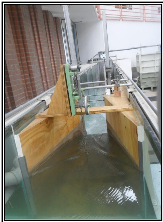
Figura 72. Comportamiento del flujo para una rugosidad con arena de 2 mm.
