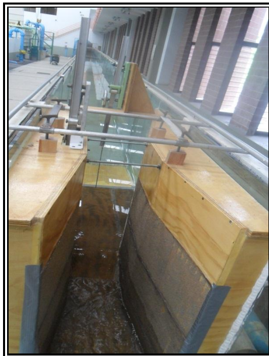
Figura 55. Rugosidad con arena de 2 mm de diámetro.
