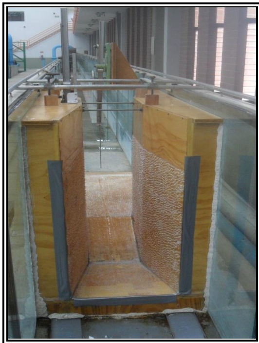
Figura 74. Rugosidad hecha con silicón de 4 mm de diámetro.
