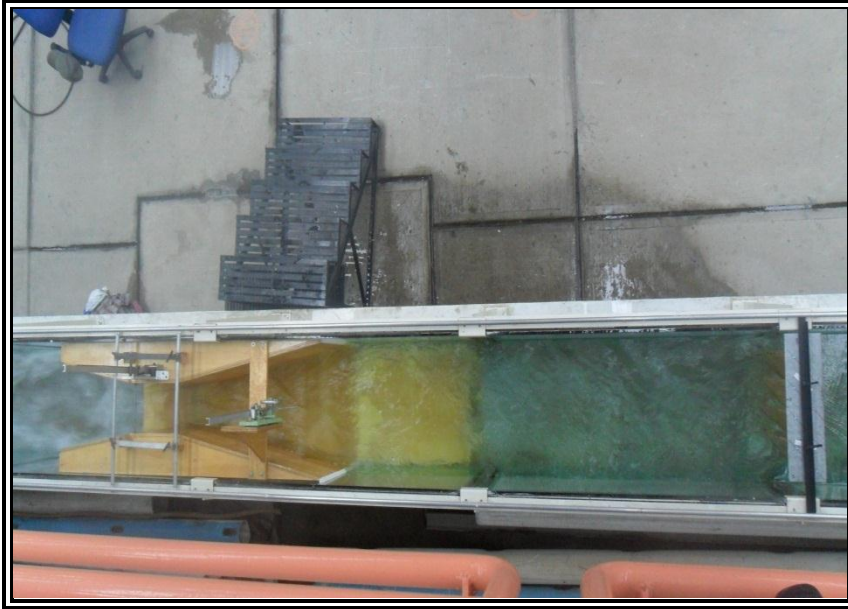
Figura 108. Colocación del desviador a 2.28 m antes del modelo, vista en planta.
