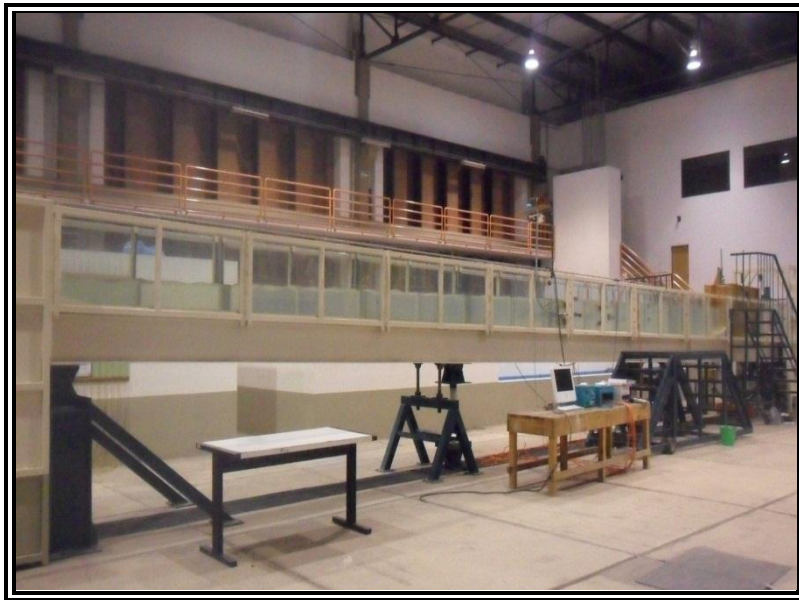
Figura 129. Canal de pendiente variable con S = 0.0192 .
