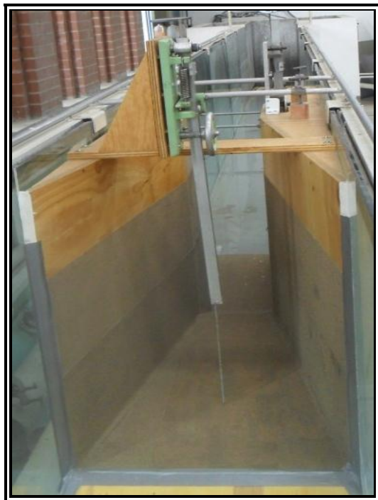
Figura 71. Rugosidad hecha con arena de 2 mm de diámetro.
