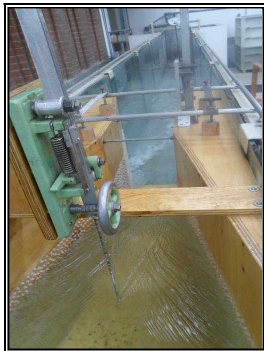
Figura 79. Comportamiento del flujo para gastos altos para una rugosidad de 6 mm.
