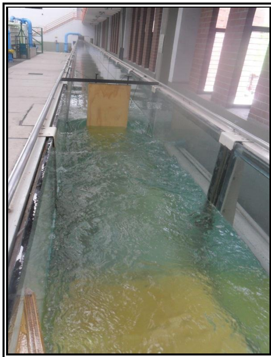
Figura 93. Formación de vórtices al interceptar el flujo en la pantalla ubicada a 2.28 m.
