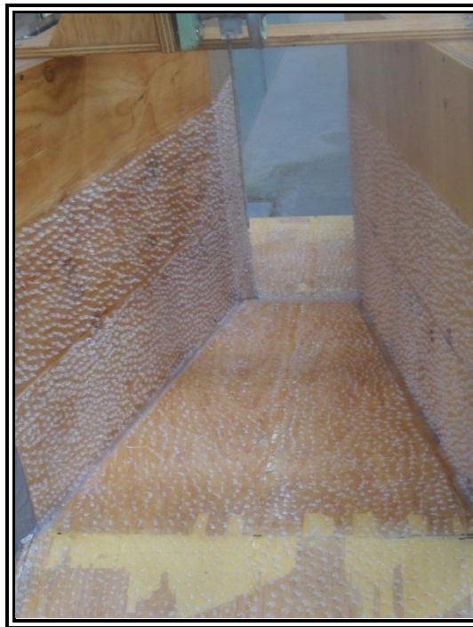
Figura 57. Rugosidad hecha con silicón de 6 mm de diámetro.
