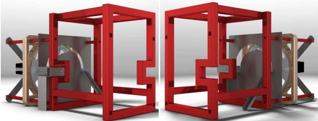
Figura.4.14.3 Sistema sujetador de la mazorca ensamblado con el bastidor
