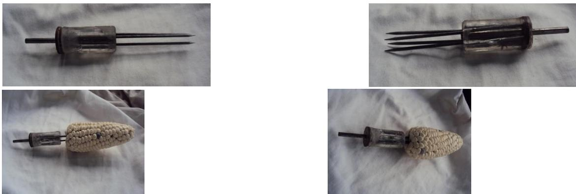
Figura 4.9.1 prototipos experimentales de puntas insertables en la mazorca
