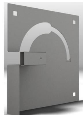
Figura.4.13.10 Lámina (1) barrera de residuos de polvo y grano originados por el corte.
