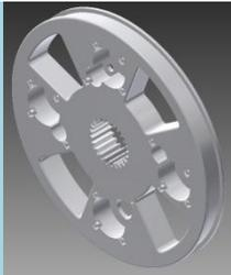
N°1   | Pieza encargada de alojar a los mecanismos que sujetarán a la mazorca.                                  |
