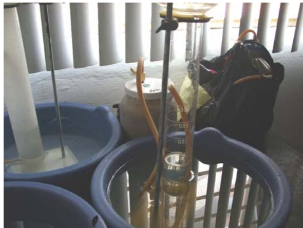
Figura 3.7 Medición del volumen del biogás por desplazamiento de agua
