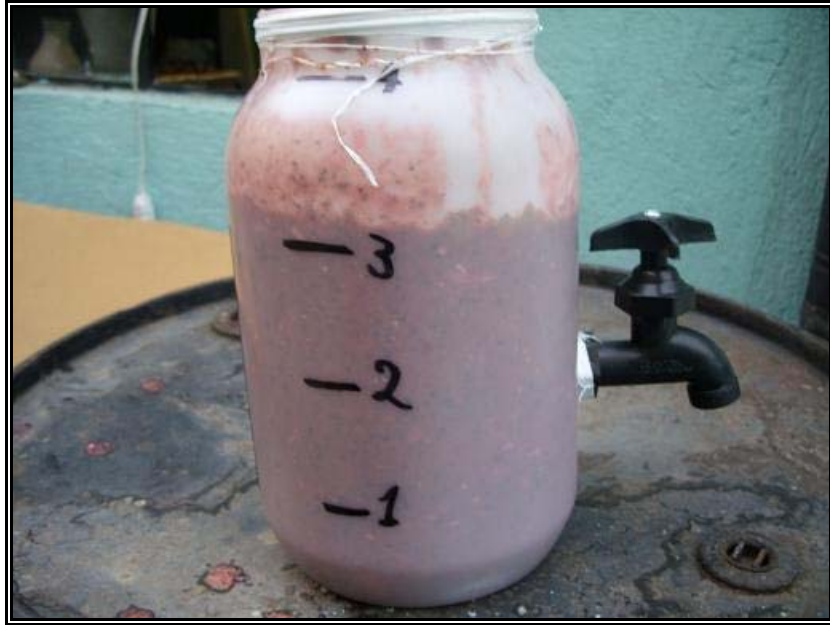
Figura 3.8 Fotografía del digester con la carga inicial del arranque
