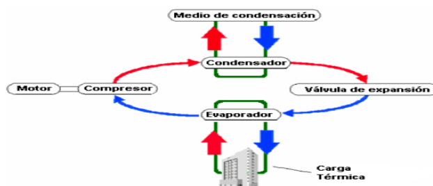
Figura 10: Enfriadora de agua (Chiller)
