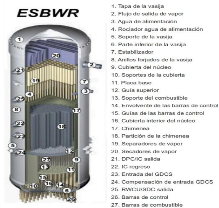
Figura 5.6: Componentes de la vasija de un reactor ESBWR
