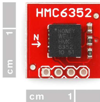
Figura 19. Brújula digital modelo HMC6352 y dimensiones.
