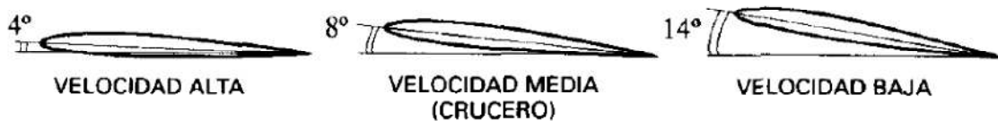
Figura 75. Relación entre ángulo de ataque y velocidad.
