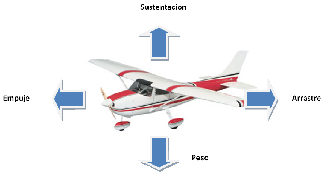
Figura 72. Fuerzas ejercidas sobre un avión.
