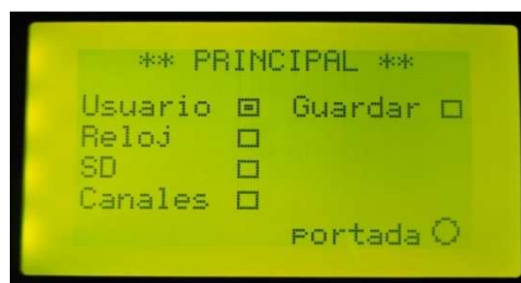
Figura 4.4 Acceso a las diferentes ventanas Mediante la entrada principal
