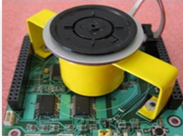
Figura 1. 5. Subsistema de estabilización por rueda inercial de SATEDU
