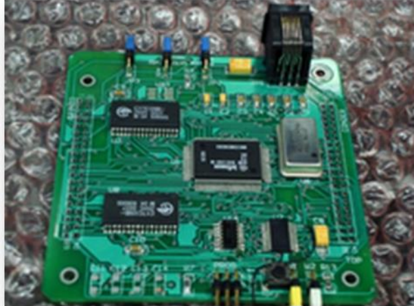
Figura 1. 3. Primera versión de Computadora de Vuelo de SATEDU
