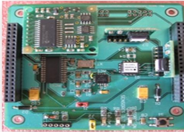
Figura 1. 7. Subsistema de sensores de Navegación Inercial de SATEDU
