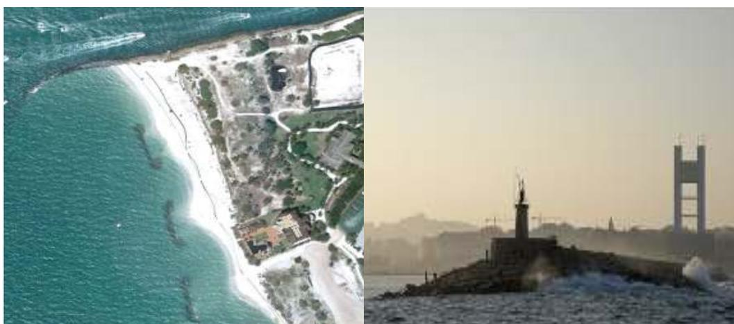
**Figura 1.** Recuperación de playas por medio de rompeolas sumergidos (izq.) y generación de una zona de abrigo con el uso de un dique con espaldón (der.)
