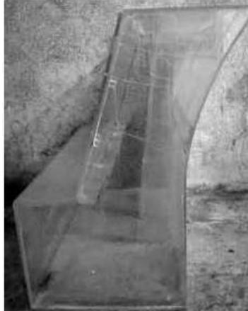
Figura 1.5 Modelo experimental de un espaldón de pared curva (Li *et al.*, 2011)
