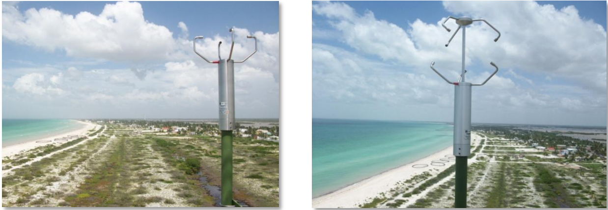
Figura 3.2-3 Vista de anemómetros desde torre. Izquierda: Anemómetro 2D, Derecha: Anemómetro 3D
