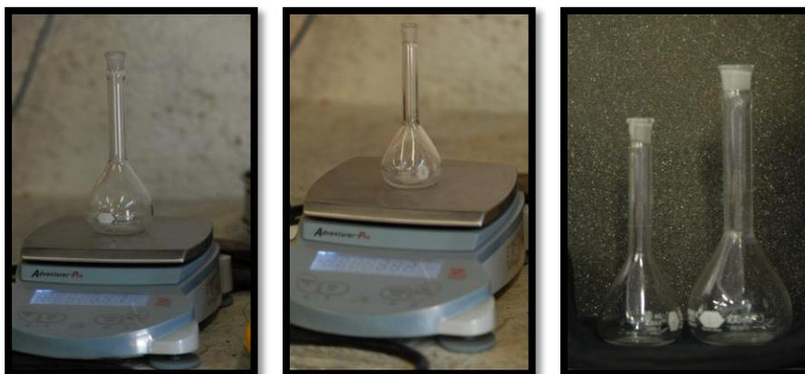
Figura 3.5 Matraces de aforo de 100 y 50 ml
