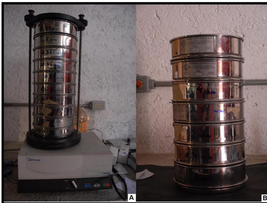
Figura 3.3 En el panel A, la máquina Ro –Top con algunas de las mallas cuya aberturas van desde la malla #230 (0.063 mm) hasta #25 (0.71 mm). En el panel B, las mallas con aberturas mayores, a partir de la malla # 4 (4.76 mm).
