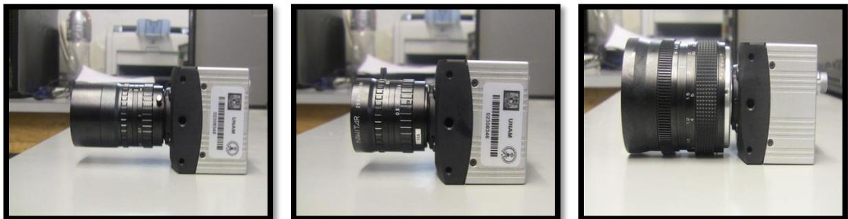
Figura 3.11 Lentes de 17 mm, 25 mm y 50 mm, de izquierda a derecha
