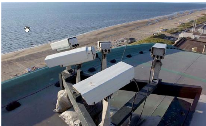
Figura 3.1 Configuración del sistema Argus, Egmondaan, Países Bajos.
