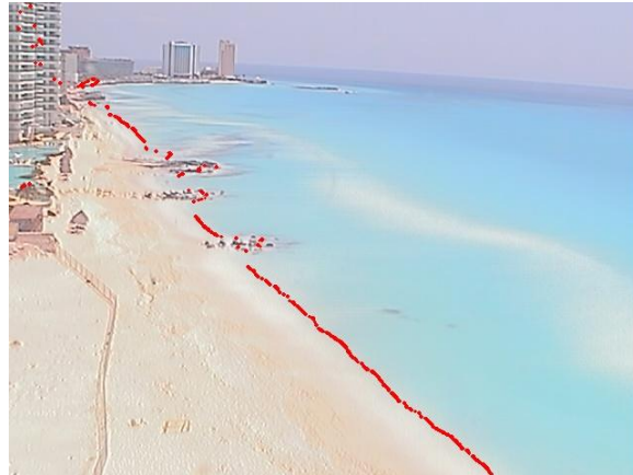
Figura 3.15 La línea de costa resultante con el modelo SDM, parámetros p_1=5 y p_2=1
