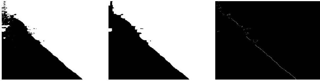
Figura 3.14 a) Imagen binarizada; b) Imagen resultante de aplicar operadores morfológicos; c) Imagen resultante de aplicar un detector de bordes.
