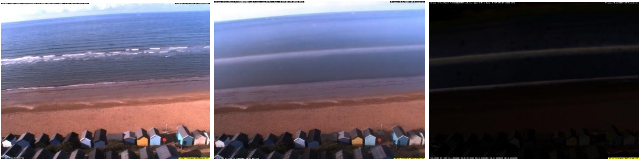
Figura 3.2 Imágenes de muestra tomadas por el sistema ARGUS instalado en Milford en Sea, Reino Unido: a) Fotografía instantánea; b) Imagen promedio; c) Imagen varianza
