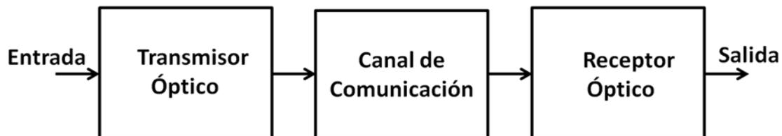
Figura 1.1. Sistema de Comunicaciones Ópticas Genérico [2]
