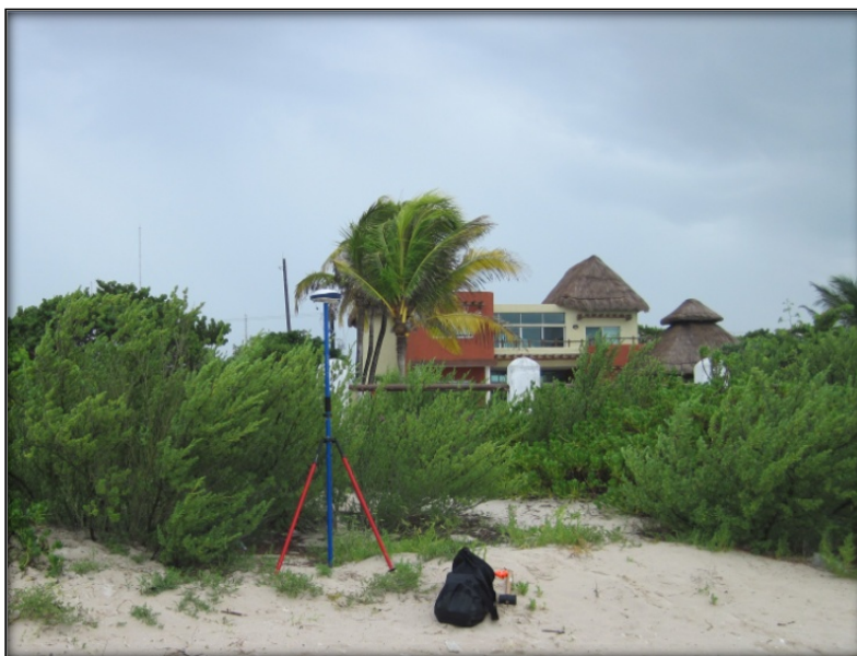
Figura 4-1 La imagen muestra la instrumentación en campo de un GPS como base fija.
