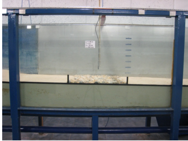
Figura A.7 Evolución del perfil de playa en la zona de rompientes para T=3s , H=12cm , \phi=1in y t=000min .
