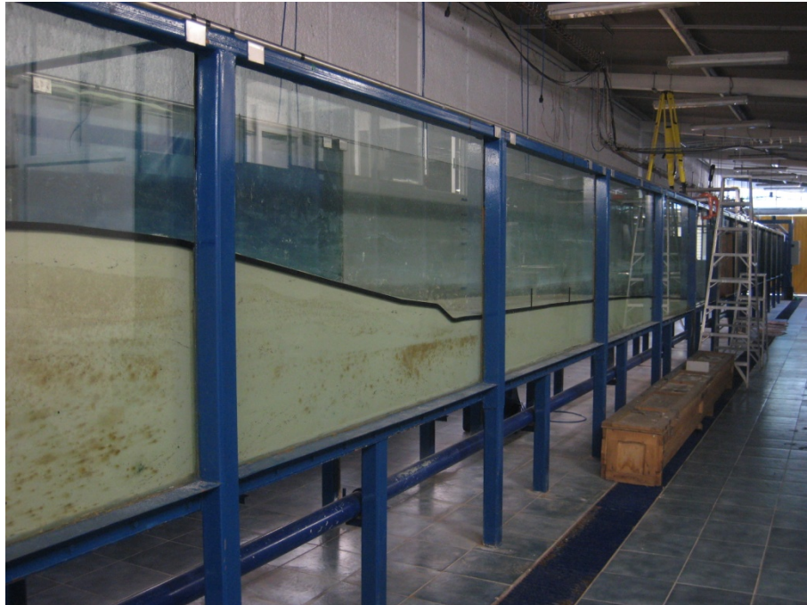
Figura 4.1 Canal de oleaje del Instituto de Ingeniería.
