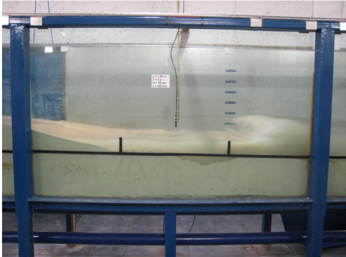
Figura 5.5 Forzamiento de la rotura sobre el tapete.
