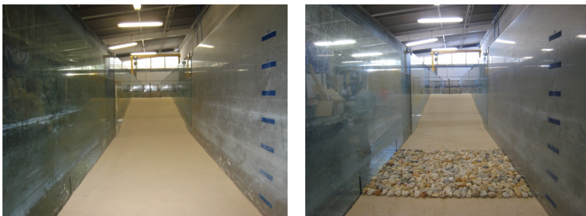
Figura 4.9 Instalación del tapete de protección, vista interior.
