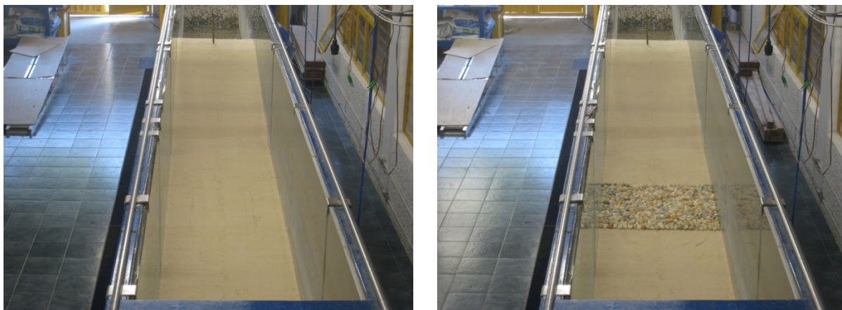
Figura 4.8 Instalación del tapete de protección, vista superior.
