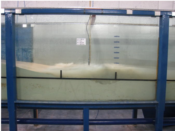
Figura 5.6 Forzamiento de la rotura sobre el tapete.
