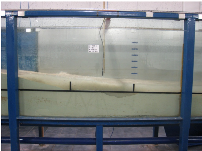
Figura 5.7 Forzamiento de la rotura sobre el tapete.
