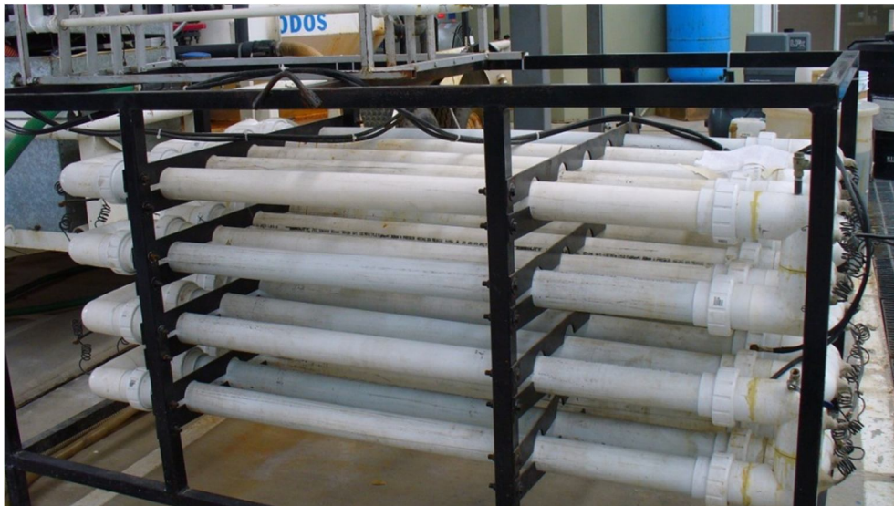
Imagen 3-2 Reactor tubular horizontal R1.
