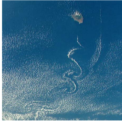
Figura. 1.1. Vórtices de Von Karman (fotografía tomada por la NASA de la isla Socorro en México, 16 de mayo de 1992)
