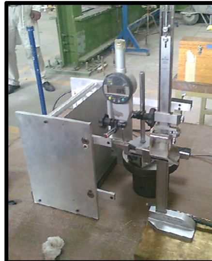
Figura 4.4.- Calibración del LVDT 044-1298 montado en el dispositivo para medir el desempeño del concreto en probetas normalizadas de 15cm x 30cm, con apoyo de un vernier y un micrómetro.
