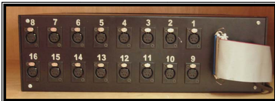
Figura 3.4 - se muestra el panel de conexiones tipo plug dim, que es la entrada de señales de los sensores, así como la conexión a la tarjeta de adquisición.
