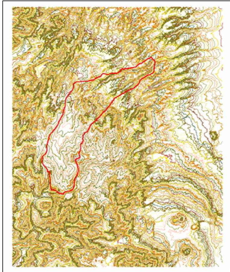
Fig. 4.11 Curvas de nivel de la zona poniente del D. F. y cuenca digitalizada del río Mixcoac
