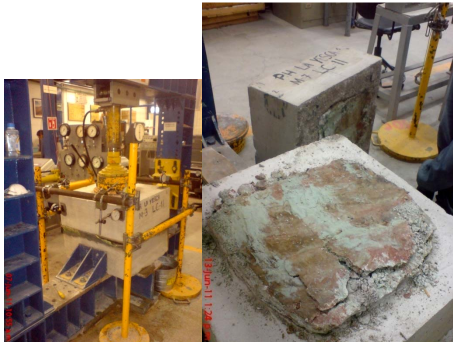
Figura 3.14. Aspecto del material arcilloso de la falla Colapso, después del ensaye de corte directo, muestra MC3-LC11
