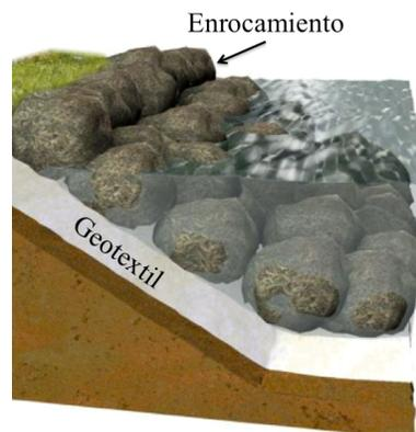
Figura 2.22 Colocación del geotextil entre la protección marginal y el talud del terraplén
