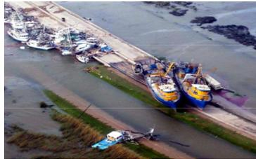
Figura 2.9 Ejemplo de mecanismo de falla por impacto estructural (Briaud, 2011)
