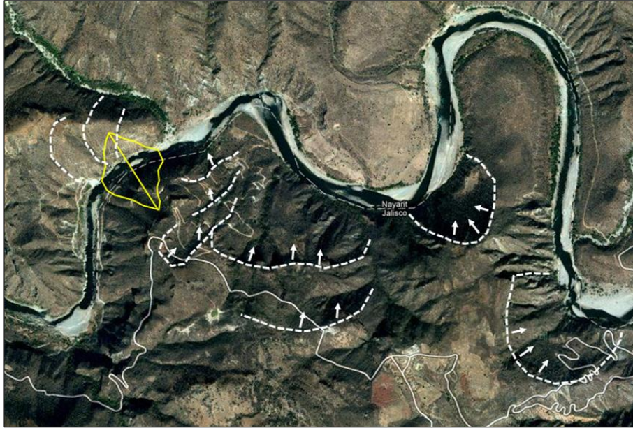
Figura 4.02.- Imagen del sitio del P. H. La Yesca. Identificación de rasgos estructurales.
