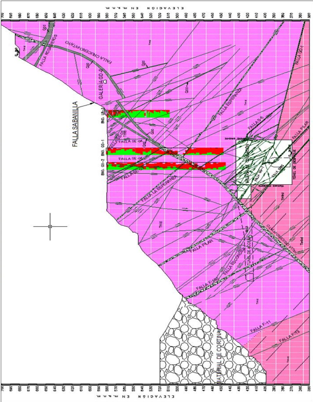
Figura 2.63.- Sección geológica por la galería de oscilación.
