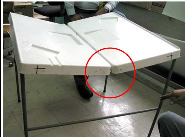
Figura 9. Pandeo al momento del ensamble.
