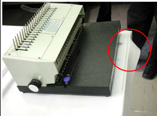
Figura 10. Ondulación en la pieza bajo carga.
