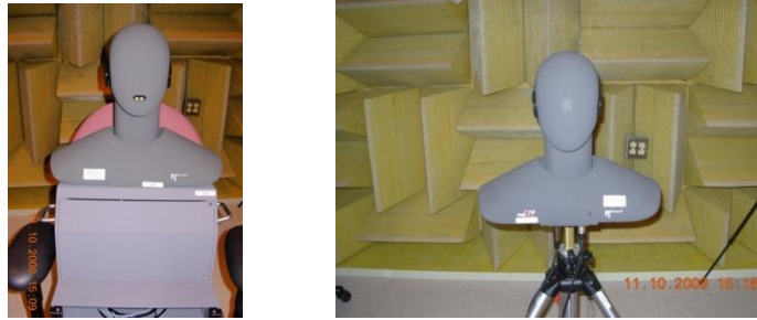
Figura 4-1: Maniqués con los que se realizó la grabación binaural. El maniquí HSM II.3 (izquierda) reprodujo la señal de voz, mientras que el maniquí HSM III (derecha) grabó la señal.
