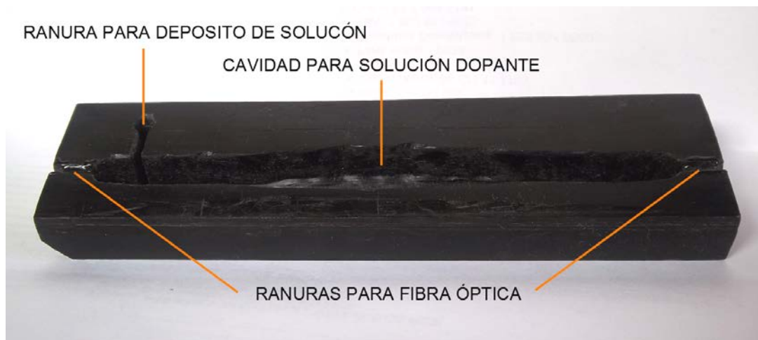
Figura 3.6. Contenedor para manejo y dopaje de microalambres de AsSe/PMMA.
