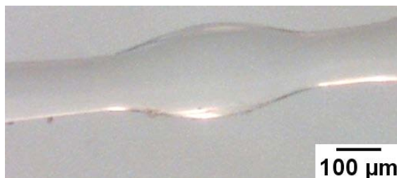
Figura 4.4. Imagen de una aglomeración de PDMS sobre la fibra óptica, debida al uso de velocidades altas del proceso de recubrimiento.
