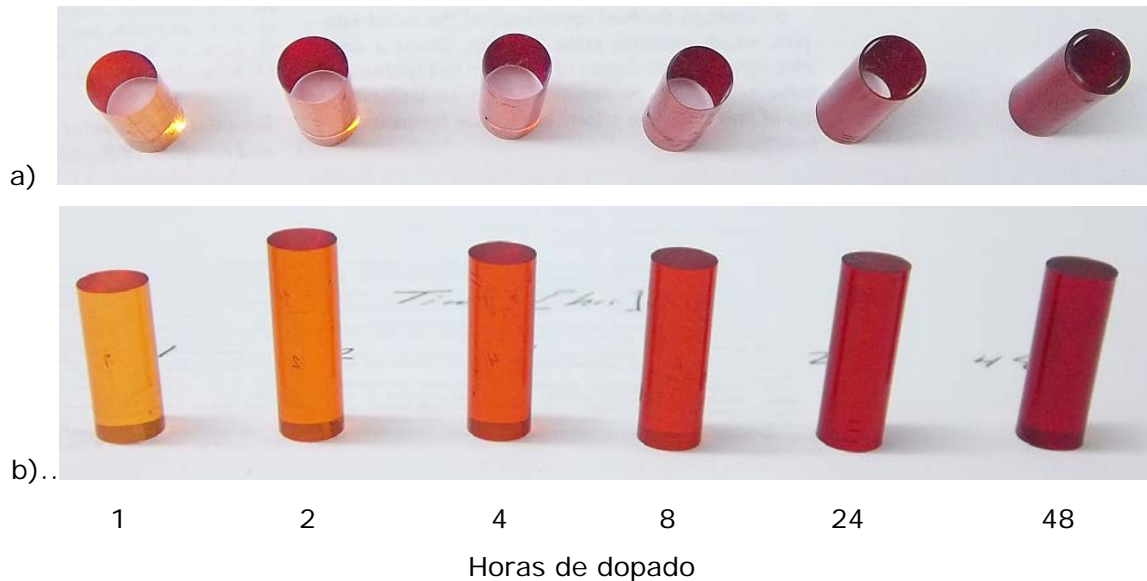
Figura 3.1. Cilindros sólidos de PMMA dopados con DR1: a) vista de cortes transversales de las muestras y b) vista de la sección longitudinal de las muestras.
