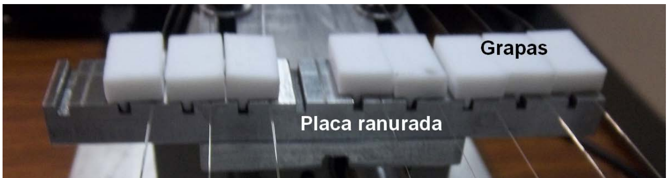
Figura 4.5. Placa ranurada y grapas para fijar los dispositivos de fibra óptica.
