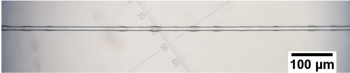
Figura 4.15. Fotografía del recubrimiento de PDMS no homogéneo realizado sobre una fibra óptica adelgazada causado por un mal alineamiento de la fibra.
