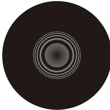
**Figura 5.9.:** Pantalla de Hartmann con los niveles de grises.
