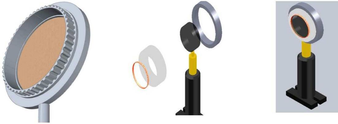
**Figura 2.3.:** Adaptación de una banda dentada al polarizador para su automatización
