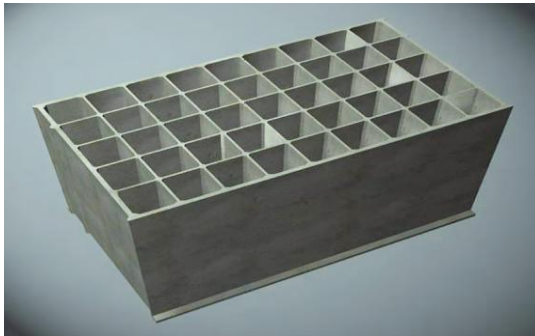
Figura 4.16. Cajón de celdas rectangulares. (GBP Obras Marítimas España 2008).
