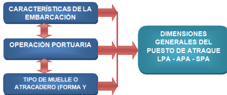
Figura 1.7. Elementos para el dimensionamiento de los P.A. (Manual de Dimensionamiento Portuario S.C.T. México).
