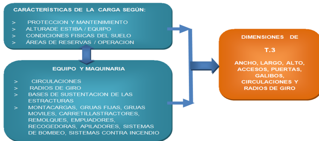
Figura 1.11. Elementos que intervienen en el dimensionamiento de T.3. (Manual de Dimensionamiento Portuario S.C.T. México 2001).
