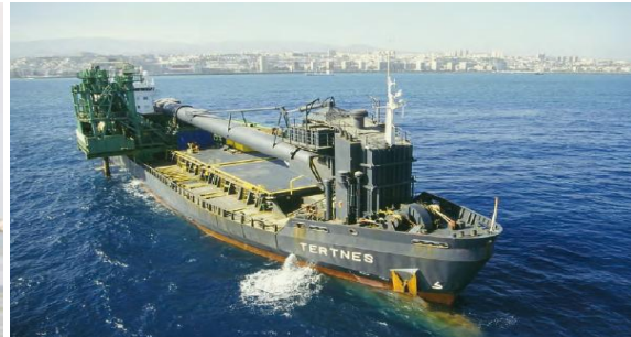
Figura 4.4. Enrasador a gran profundidad (IDEM 4.4).
