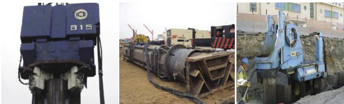
Figura 4.35. Equipo de hincado: Vibrohincador, martillo hidráulico y prensa hidráulica (Martins 2008).
