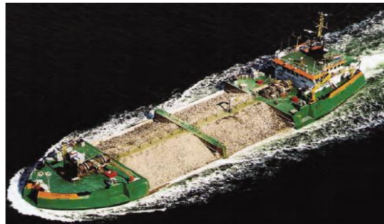
Figura 4.2. Gánguil de vertido lateral (IDEM 4.1).
