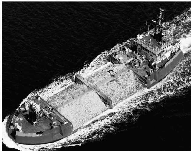
Figura 4.8 Gánguil de vertido lateral
