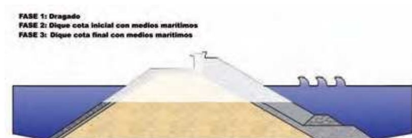
Figura 4.3 Relleno y consolidación
