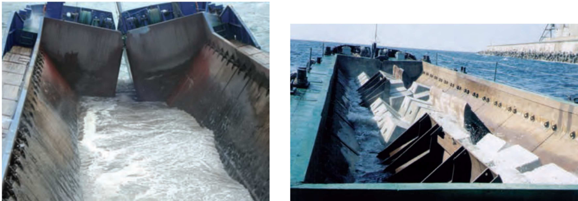
Figura 4.7 Gánguiles con apertura de fondo
