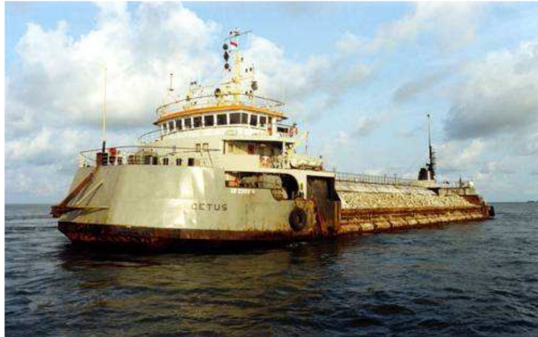
Figura 4.9 Gánguil de vertido lateral
