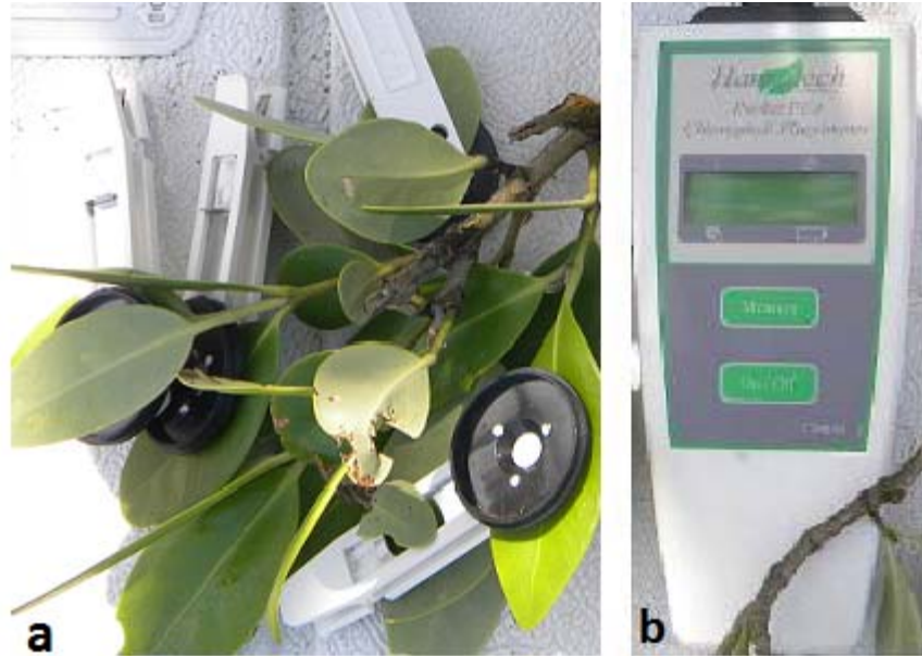
Figura 6.3 Determinación de la eficiencia fotosintética con el equipo Pocket PEA de Hansatech. a) Pinzas para la adaptación a la oscuridad colocadas en las muestras foliares. b) Fluorímetro Pocket PEA utilizado para la cuantificación de la fluorescencia de la clorofila a .
