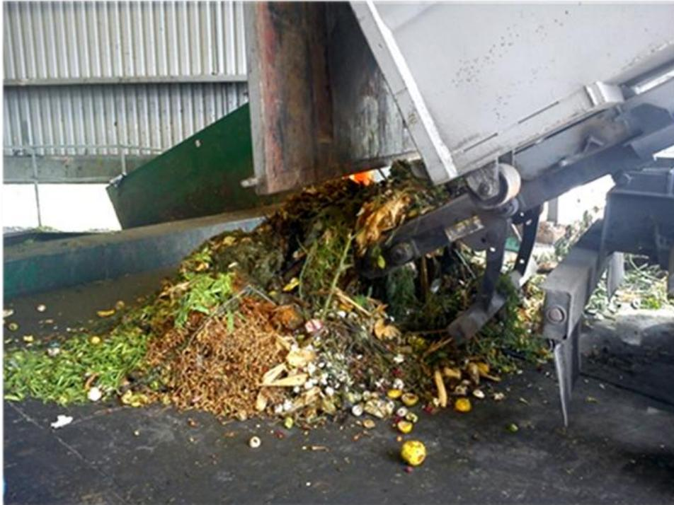
**Figura 7.1. Descarga de los camiones junto a la tolva**
