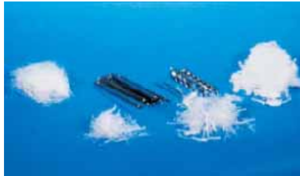
Figura 3.1 – Fibras de acero, de vidrio, sintéticas y naturales con diferentes longitudes y formas para uso como refuerzo de concreto. (Adaptada de PCA, 2004)
