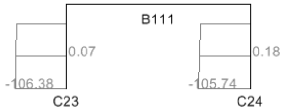
Figura 5.10 Diagrama de fuerza axial para COMB2 en el quinto nivel
