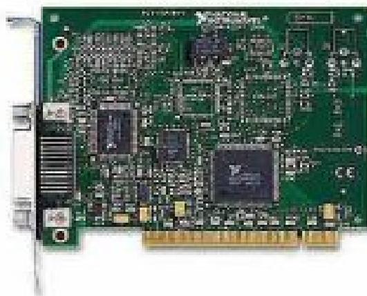
**Figura 4.3: Tarjeta GPIB-PCI para computadoras.**
