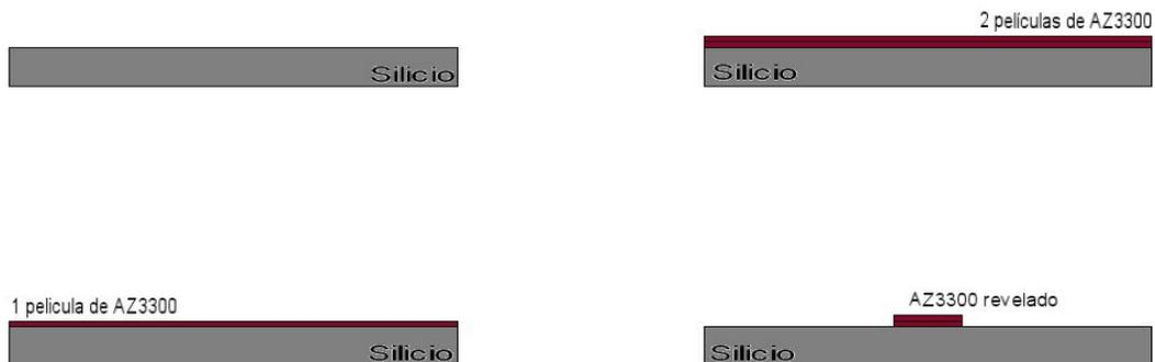
**Figura 3.3:** Esquema general que muestra las secuencias de fabricación del bolómetro.
