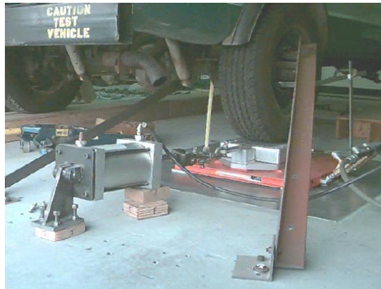
Figura 2.3: Sistema experimental para medir la rigidez de la llanta.
