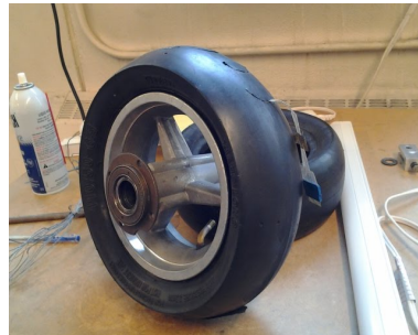
Figura 2.17: Llanta utilizada en el banco de pruebas, “ smart tire ”.
