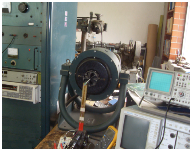
Figura 5.6: Colocación de una galga extensométrica en un excitador electrodinámico.
