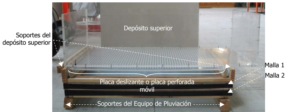
d. Equipo de pluviación.
