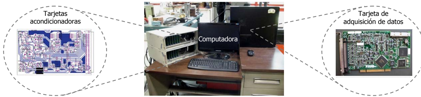
a. Computadora, tarjeta de adquisición de datos y tarjetas acondicionadoras.
