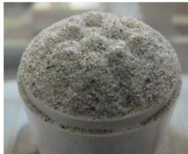
b. Pluviación con empleo de placa perforada.
