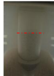
c. Pluviación con empleo de mallas.
