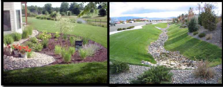
Figura 5.4 Sistemas de bioretención. Jardín de lluvia (izquierda) y cuenca de retención (derecha).
