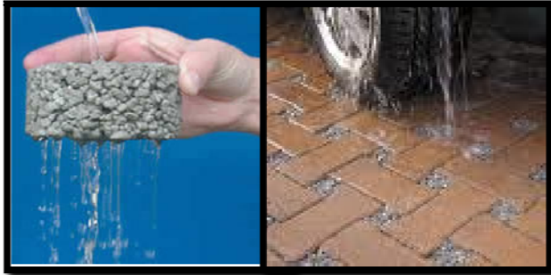
Figura 5.3 Concreto Permeable. La porosidad de éste material se debe a su alta relación de vacíos que hacen del concreto permeable una opción ecológica para pavimentar sin disminuir notablemente la permeabilidad del sitio. Fuente: Sitio web Concreto Permeable
