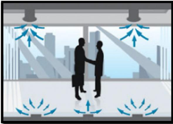
Figura 3.3 Sistema de aire acondicionado: ventilación por desplazamiento. Fuente: Sitio web Mundo HVAC
