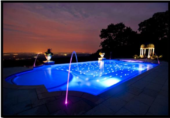
Figura 3.8 Fibra óptica subacuática. Mediante el uso de sistemas de iluminación puntual se puede conectar lentes subacuáticos para iluminación de albercas. Las principales ventajas del uso de la fibra óptica es que no conduce electricidad, calor o gases, permite el cambio de color en la iluminación, es muy durable, de bajo consumo energético y prácticamente no necesita mantenimiento. Fuente: Sitio web *Architecture Things*
