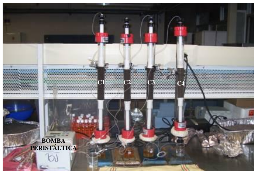
Figura 0.22 Operación de las columnas empacadas: C1 es testigo, C2, C3 y C4 son réplicas y se alimentan al mismo tiempo por medio de una bomba peristáltica.
