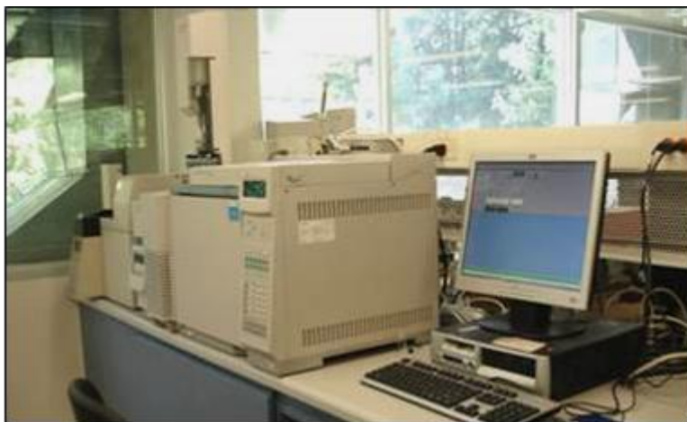
Figura 0.9 Cromatógrafo de Gases HP 6890N, acoplado a un detector selectivo de masas modelo HP 5973N.
