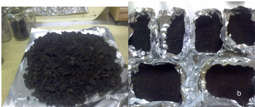
Figura 5.2 Preparación de suelo en laboratorio a) secado a temperatura ambiente, b) tamizado y homogenizado.
