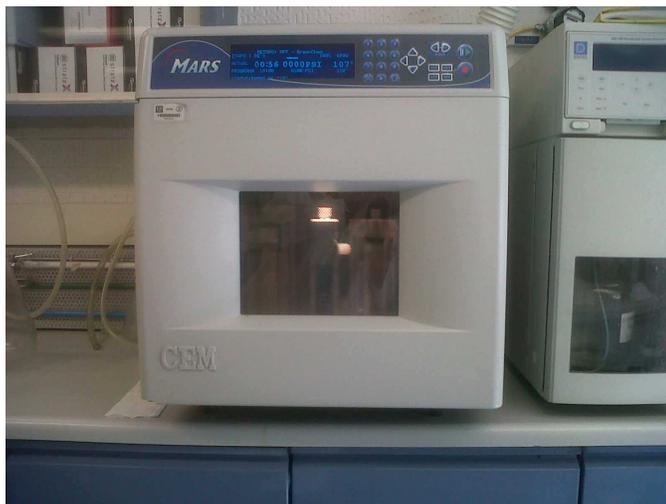
Figura A2. Etapa 1 de la extracción con microondas.
