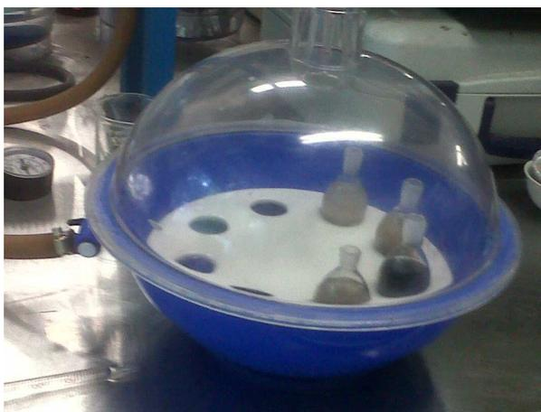
Figura A1 Picnómetros en el desecador al vacío para obtener la densidad real
