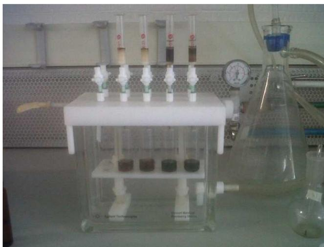
Figura A4. Cartuchos SUPELCO en el manifold para la filtración de muestras.
