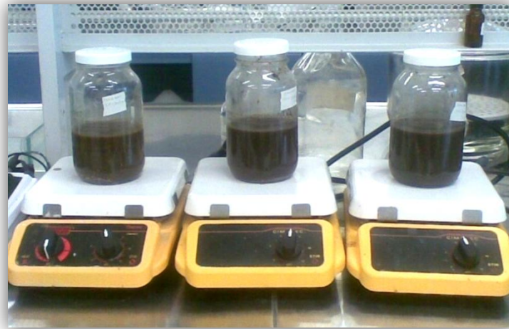
Figura 3.5 Sistemas de reacción aplicados en el pre-tratamiento químico de los bagazos provenientes de la FORSU
