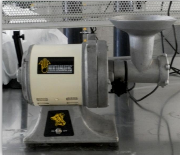
Figura 3.1 Extrusor empleado para la reducción del tamaño de partícula de la FORSU
