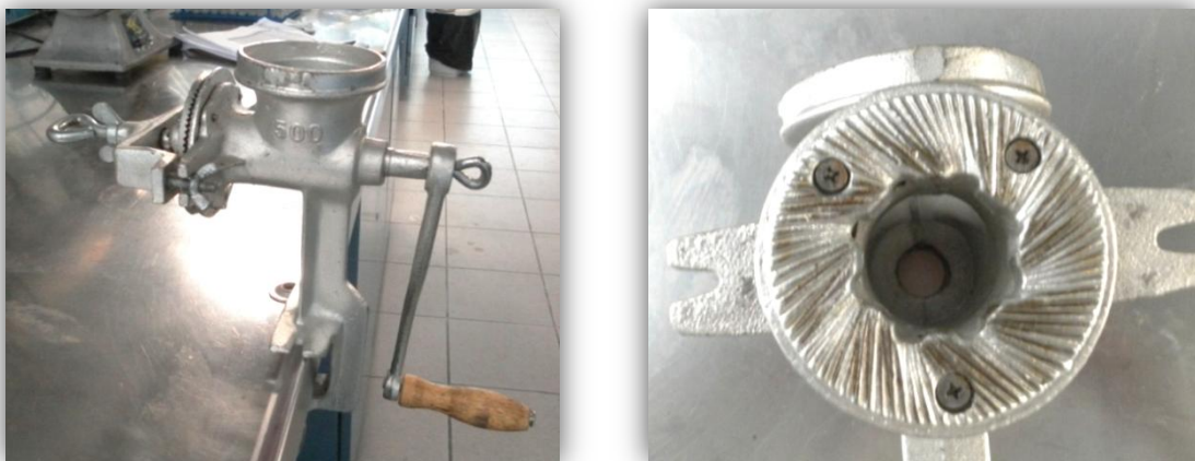
Figura 3.2 Molino de mano empleado en la reducción del tamaño de los residuos orgánicos
