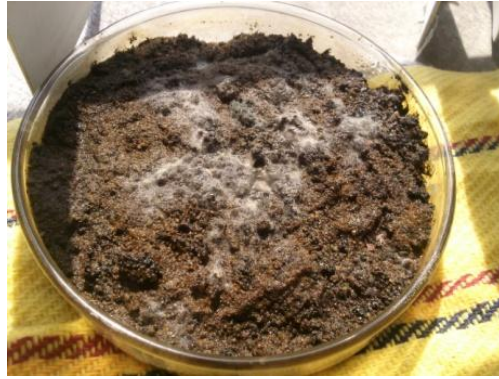
Figura 4.4 Presencia de hongos a las 72 h de saturación de la muestra inalterada.
