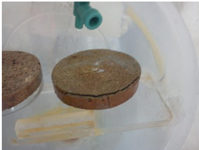
Figura 6.32 Fractura de bloques por exposición a lluvia ácida.
