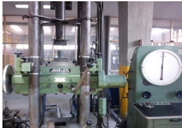
Figura 6.7 Ensayo de bloques a carga axial.
