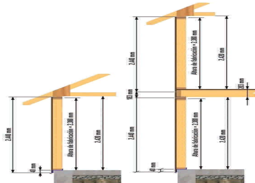
Figura 176. Altura del primer y segundo nivel con muros de madera sentados sobre cimentación de concreto
