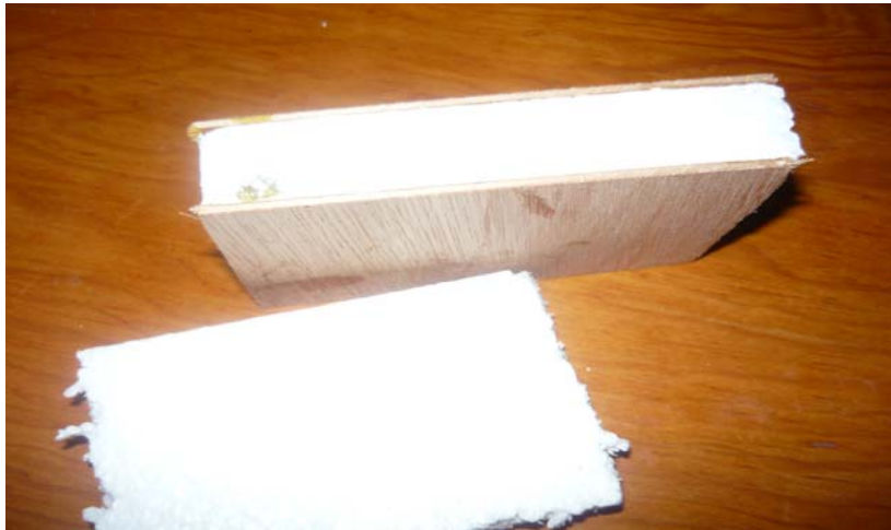
Figura 217 (b). Polietileno cubierto con dos capas de triplay, formado un panel tipo sándwich.
