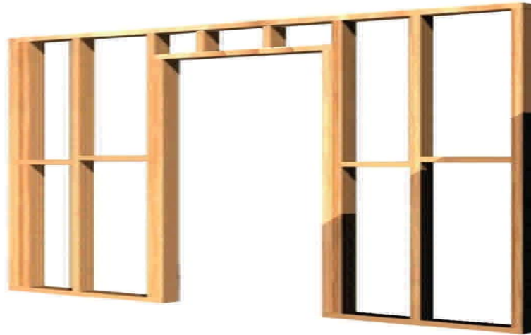
Figura 171. Entramado de un muro divisorio no estructural.
