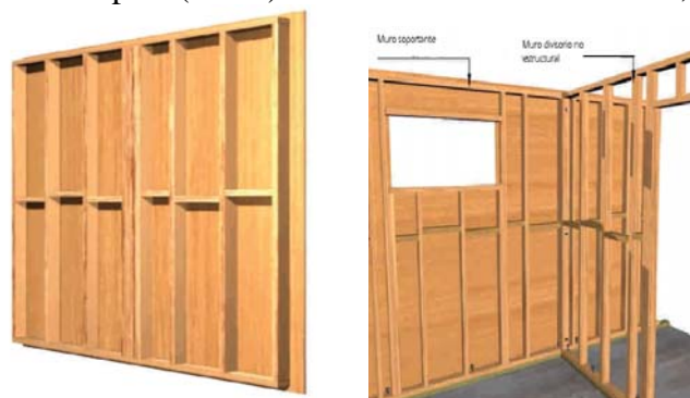
Figura 170. Muros con elementos arriostantes con tableros de madera contra chapada, y muros soportante estructural y muro divisorio.
