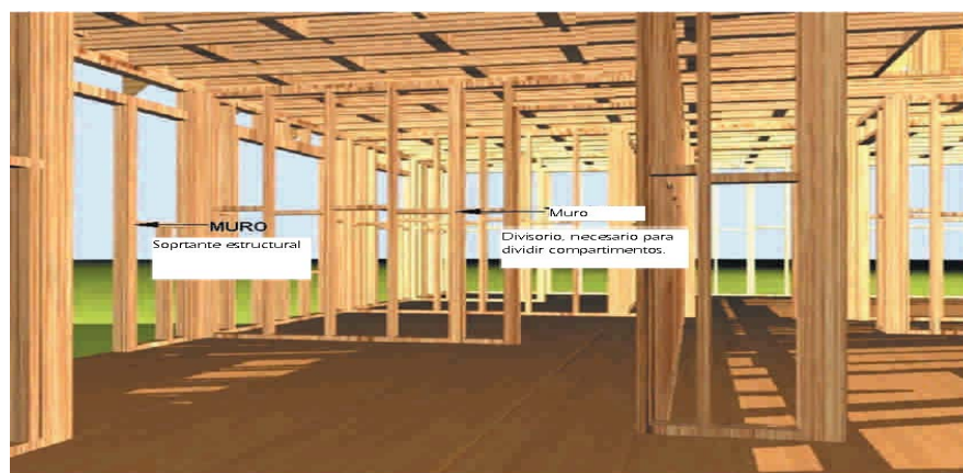
Figura 169. Muros soportantes y muros divisorios.
