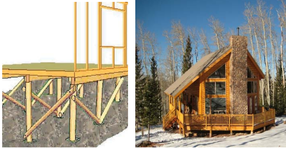
Figura 159. Arrostramiento permanente de pilotes de madera de más de un metro de altura y cimentación de una casa sobre pilotes de madera.
