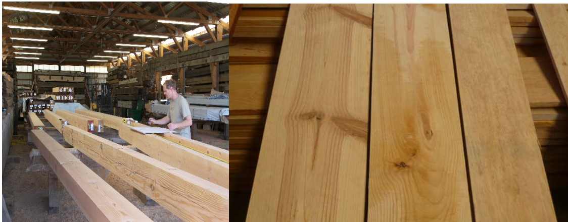
Figura 65. Vigas de madera maciza y tablones.
