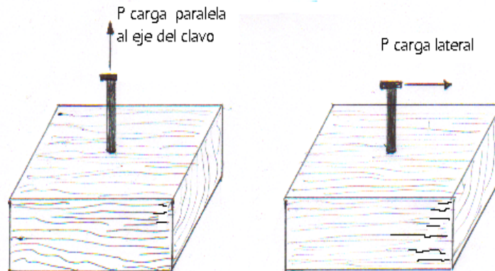
Figura 95. Dirección de la carga en las uniones con clavos.
