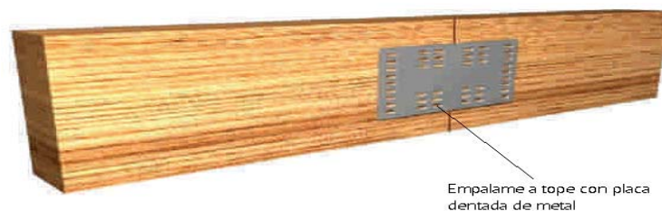
Figura 87. Empalme a tope mediante placas dentadas
