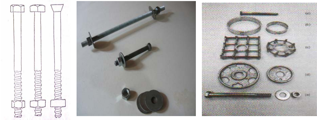
Figura 103. Pernos con cabeza hexagonal, y espárrago de cuerda continua con rondana y tuerca, además algunos elementos especiales como placas y anillos de metal.
