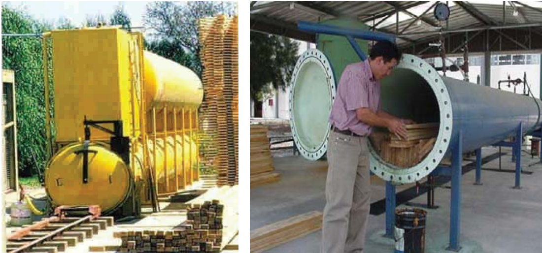
Figura 52. Cilindro donde se introduce la madera junto con el preservador, en el cual se somete a presión-vacío.
