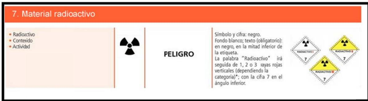
FIGURA 0-36. etiqueta para MATERIAL RADIOACTIVO. fuente: <http://cargainfo.com>
